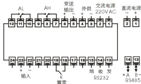
只有热电偶输入时, 需要装冷端感温元件, 其它输入信号则不装。
